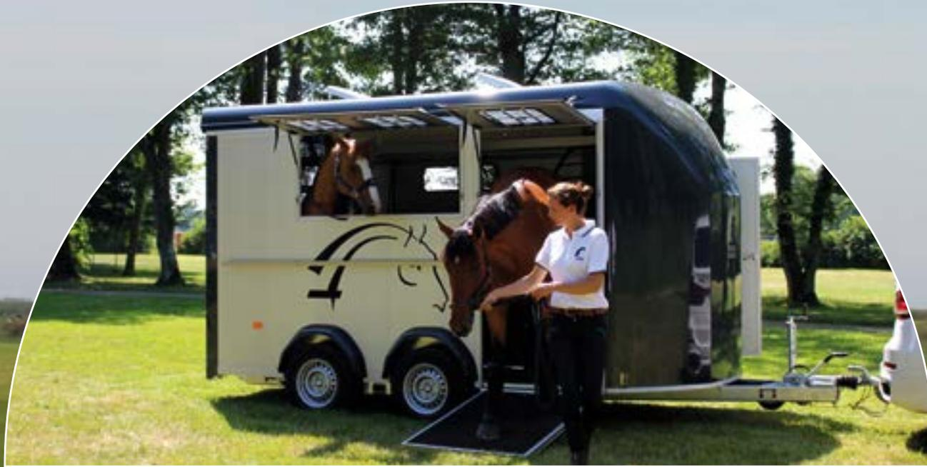
Die teleskopischen Trennwände öffnen sich komplett und können sich gegen die Wände drücken um das Einsteigen der Pferde nicht zu stören. Sie drehen sich auf die Achse um vorne verriegelt zu werden nachdem das Pferd eingestiegen ist. Der Abstand zwischen den Trennwänden ist verstellbar, um sich am besten an der Größe des Pferdes anzupassen.
