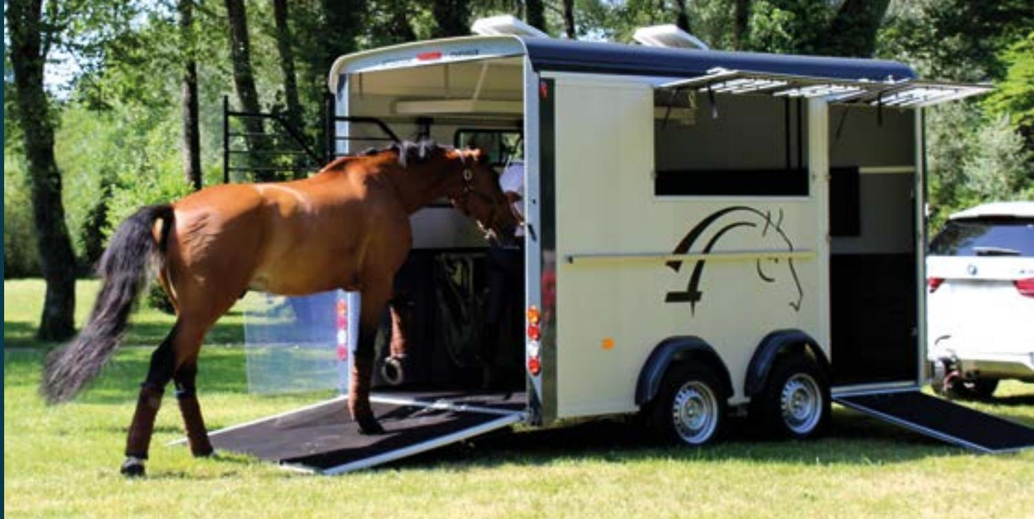
Gesicherter Ausstieg, breite Frontausstiegsrampe Richtung Ausgang
